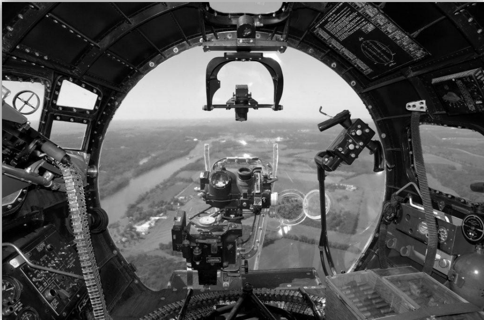
Afb. 16. Zo moeten de bombardier en navigator de aanloop naar het doelgebied hebben gezien vanuit de plexiglazen neuskoepel van hun B-17. In het midden de Norden richtapparatuur. Internet, afbeeldingen.
